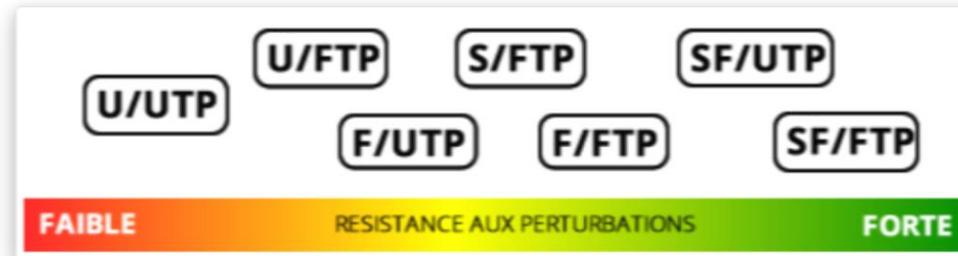
Les différentes techniques de blindages permettent aux câbles ethernet de limiter au maximum les erreurs pendant les transmissions de données. En effet, les câbles RJ45 sont composés de plusieurs fils qui, lorsqu'ils sont parcourus par un courant électrique, *rayonnent* et interfèrent entre eux. Un environnement compliqué pourra également perturber la transmission du signal. Plus le taux d'erreurs est important moins les échanges de données seront efficaces.
