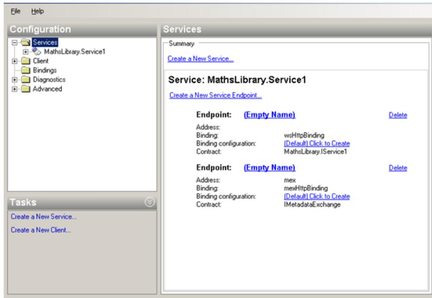
Sélectionnez le Service1 du panneau de gauche, la fenêtre suivante doit apparaître
