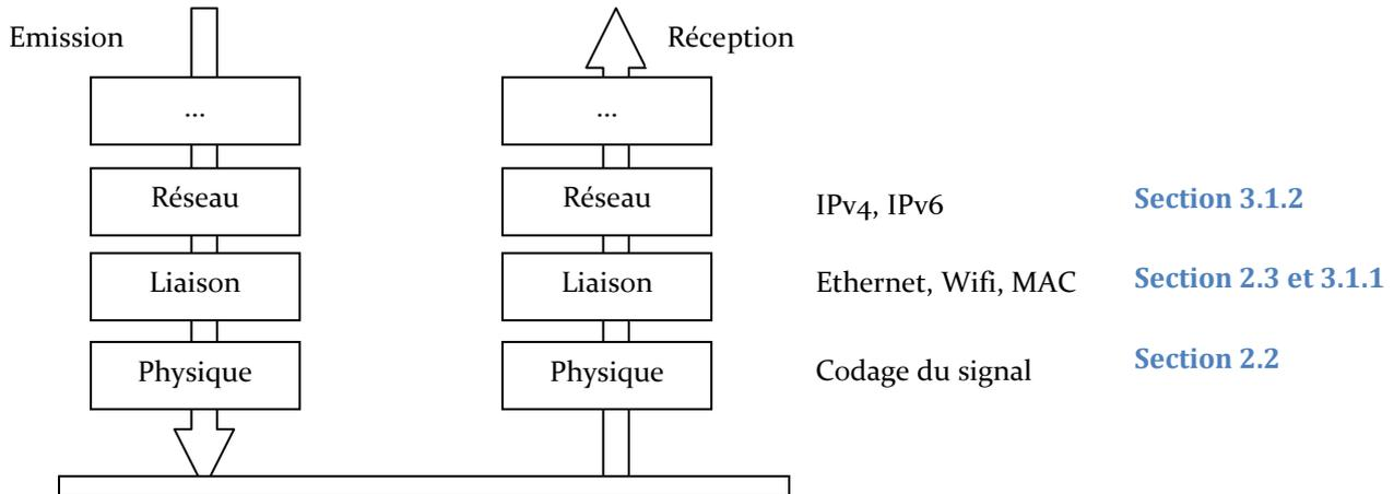
Ce modèle en couche est le Modèle OSI (Open Systems Interconnection).
