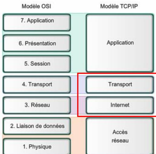
La figure ci-joint rappelle la projection de la pile TCP/IP dans la pile OSI/ISO.
