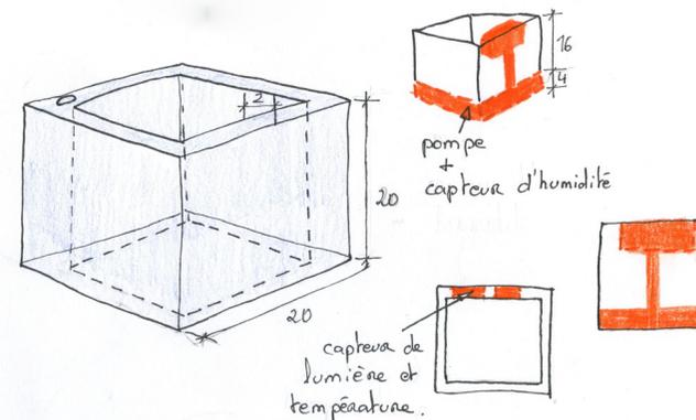
Le capteur de luminosité, de température et la pompe pour l'eau se trouveront dans un bloc blanc à l'intérieur des bords du pot carré. Les deux blocs de composants seront reliés, et le fil électrique sortira du socle à l'arrière.
